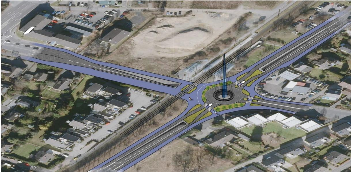
Wichtigster Vorteil der planfreien Lösungen zur Querung der Stadtbahn ist die völlige Unabhängigkeit von Schrankenschließzeiten. Weitere Vorteile sind – je nach Ausgestaltung – weitere Entflechtungen von Verkehrsströmen die neben leichterem Verkehrsfluss auch zur Erhöhung der Verkehrssicherheit beitragen können.
