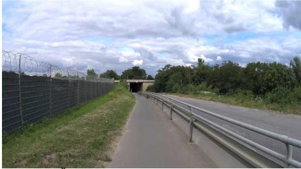
**Bild 2:** Östliche Zufahrt zur Unterführung A 3 – Schutzeinrichtung als bauliche Trennung zur Fahrbahn
