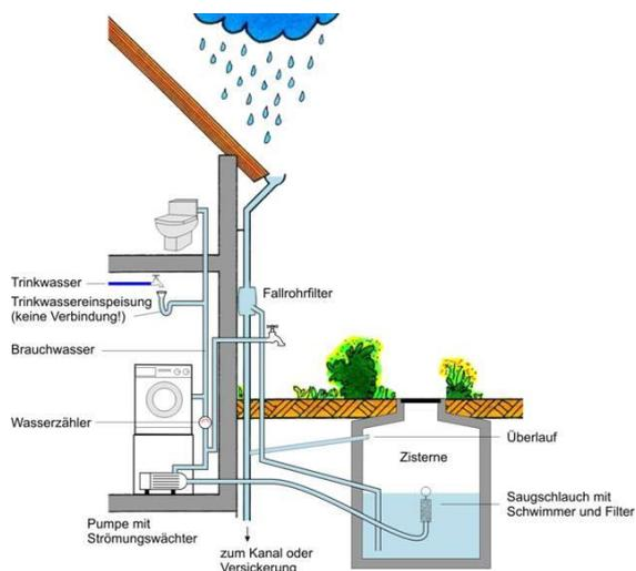
Abb. 4-6: Prinzip Regenwassernutzungsanlage
