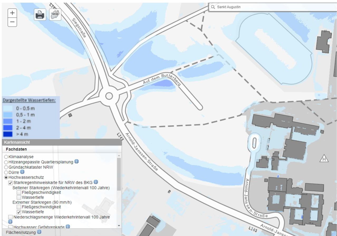
Abb. 6-2: Szenario Blockregen 90 mm/h
