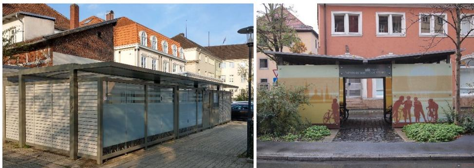
**Bild 5-1: Beispiel einer abschließbaren (links) und einer offenen (rechts) Fahrradsammelgarage**
