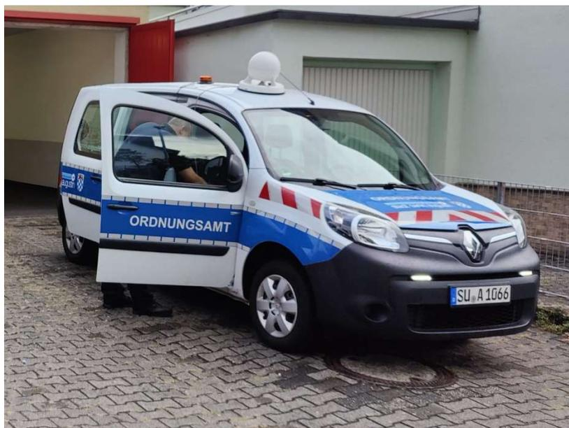
*Fahrzeug des Ordnungsamts mit auf dem Dach montierter MOBELA*
