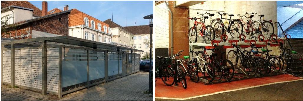
**Bild 4-4: Fahrradsammelgarage (links) und Doppelstockparker (rechts)**
