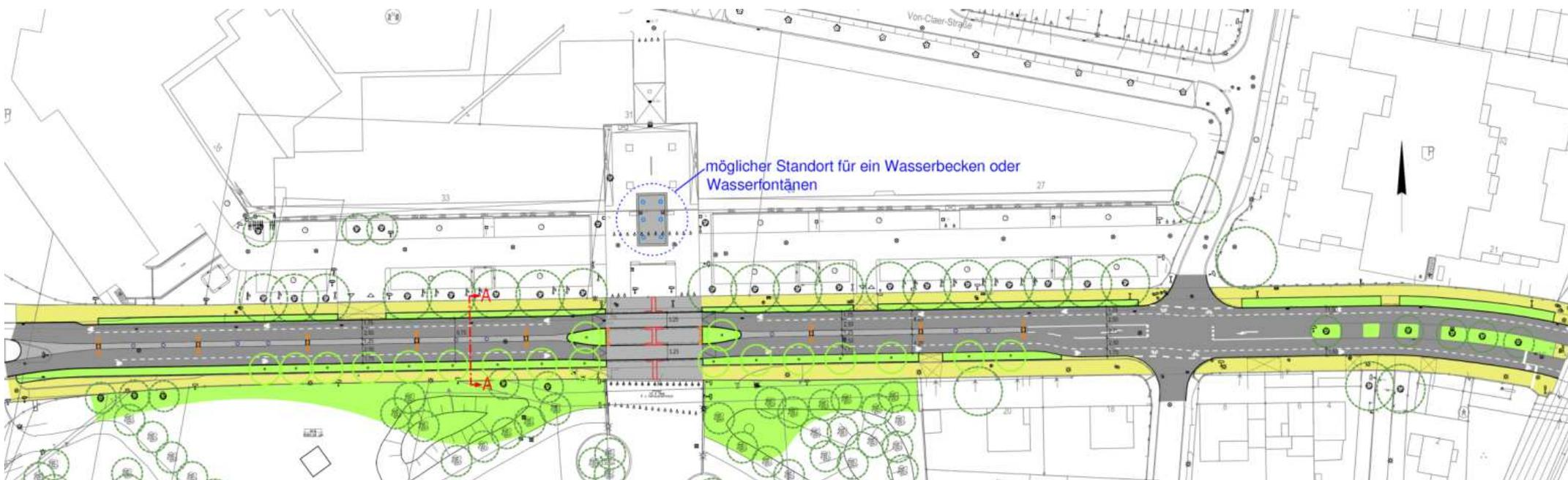
**In Variante 2 erfolgt die Hinführung in der Südstraße über einen Mittelstreifen aus Pflaster, der durch besondere Beleuchtungskörper gegliedert wird.**
