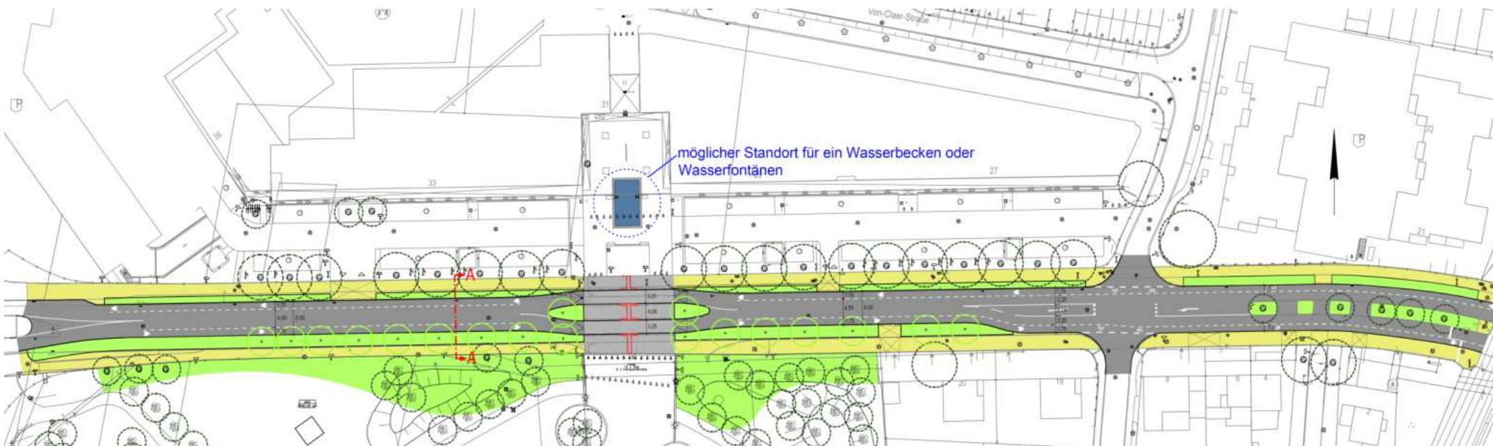
**Variante 1 versucht mit einer alleeartigen geschlossenen „Hinführung“ dem Querungsbereich um eine langgestreckte Mittelinsel herum „Raum zu geben“.**
