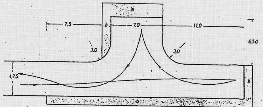
Wendehämmer sind so anzulegen und zu bemessen, daß nur ein ein- oder zweimaliges Zurückstoßen erforderlich ist. Bei den Abmessungen sind die notwendigen Freiflächen für die Fahrzeug-Überhänge zu berücksichtigen.
