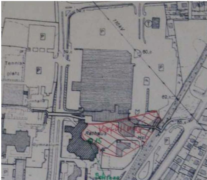
Abbildung 4: Ungefähre Lage des Verfüllbereiches in der ehemaligen Kiesabbaustätte im südöstlichen Bereich des Baufeldes (aus /6/)
